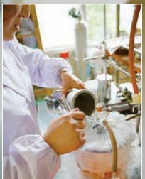
液体窒素をコップに注ぎ、反応系の温度をマイナス78℃にします。
