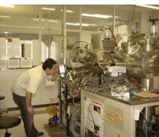
原子をならべて新しい物質を作り出すナノテクノロジーを研究しています。分子線エピタキシー装置を使い原子を並べ積み上げることで超高効率の太陽電池、超高速、高出力のナノデバイスの開発・研究を進めています。
