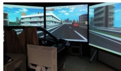
事故が発生した交差点を運転シミュレータで再現して、事故を回避する装置の有効性を調べています。
