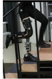
工学とバイオメカニクスを融合させ、下肢切断者の生活空間拡大を目指した義足の研究開発をしています。安全かつ確実に階段を昇ることができ、安価に製造可能な義足膝関節(膝継手)の開発などを行っています。
