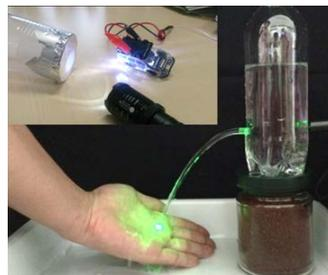
光ファイバ通信は、髪の毛ほどの太さのガラス繊維を使って、光信号を遠くまで伝える技術です。太陽電池とアルミ箔を利用した光通信の原理実験、水流を使ったレーザー光の導波実験、超高精細動画像の光ファイバ伝送実験などを通して、光ファイバ通信の仕組みを分かりやすく紹介します。
