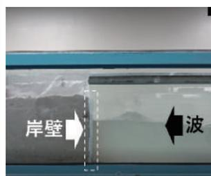
岸壁は、船が安全に荷物を積みおろしたり、人をわたすための重要な施設です。波の作用を繰り返していると、岸壁は大きく変形します。この変形の様子を実験を通じて実際に見てみましょう。
