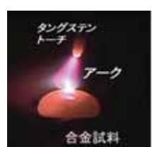
身の回りにある金属材料の殆どは合金と呼ばれ2種類以上の元素から構成されています。これはとても強くなるなど材料の特性を大きく変化させる事が可能だからです。ここでは、実際に航空機に使用されているチタン合金の溶解作業を体験してみましょう。
