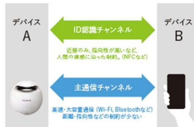
「ID認識チャンネル」と「主通信チャンネル」とに性質の違う通信手段を使い、組み合わせる
