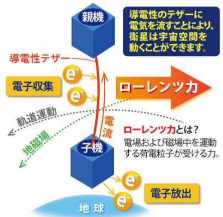
STARS-II では、実際にデブリを除去することは実施いたしません。導電性テザー技術やテザー宇宙ロボットを実証し、次以降のステップでデブリへの接近・デブリ捕獲技術を開発して、デブリ除去実現を目指します。
