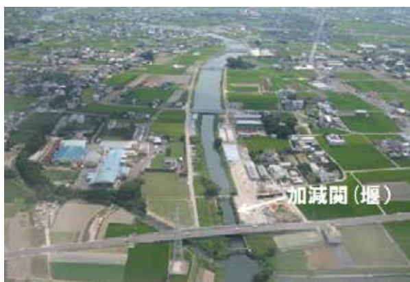
写真4 加減関で河道が狭くなっている飯尾川 《得られる知恵・教訓》
