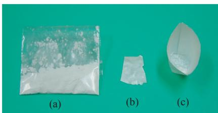
(a): 層状チタン酸粉末原料、(b): ナノ粒子から作製した層状チタン酸シート、(c): シートから作った折り紙コップ
