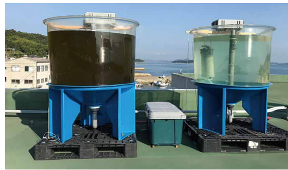
屋外での培養試験。培養開始時(右)と1日半経過した状態(左)
