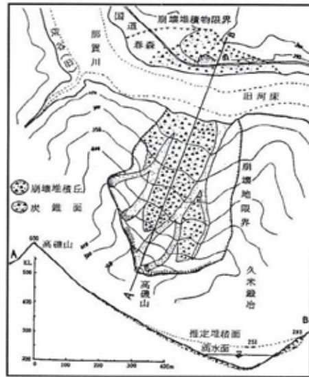
図3 崩壊地の地形分類と断面図 (寺戸、1970)
