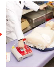
ショックの指示があった時は、誰も触れて無いことを確認してショックボタンを押します。
