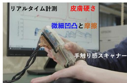
図1 基準面を一体化した高分解能半導体触覚センサ 図2 「手触り感スキャナー」による皮膚の計測
