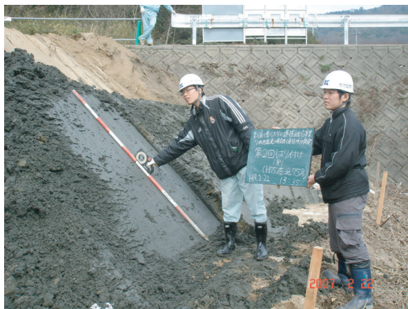
H75 試料の配合直後における貼り付け実験 勾配測定（1割勾配）（配合3.5時間後に成形，H75）
