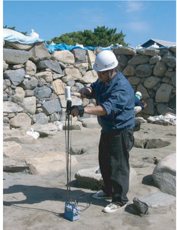
高松城での調査（携帯型簡易動的貫入試験）
