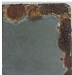
従来の防錆塗料を塗布した金属鉄板での複合サイクル試験(137サイクル)の結果
