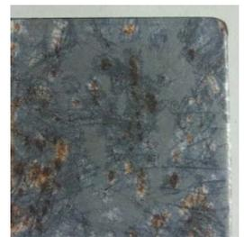
EML配合防錆塗料を塗布した金属鉄板での複合サイクル試験(137サイクル)の結果
