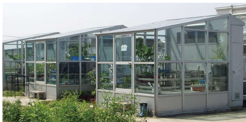
図1. 温度が桜桃の結実に及ぼす影響を調査する人工気象室の写真
