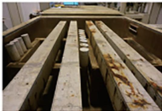
塩分により鉄筋腐食したはり
