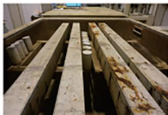
塩分により鉄筋腐食したはり
